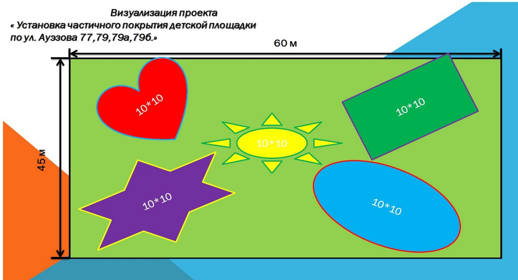
*(На данном эскизе геометрическими фигурами обозначены области для размещения отдельных частей площадки, подлежащие покрытию тартановым покрытием.)*
